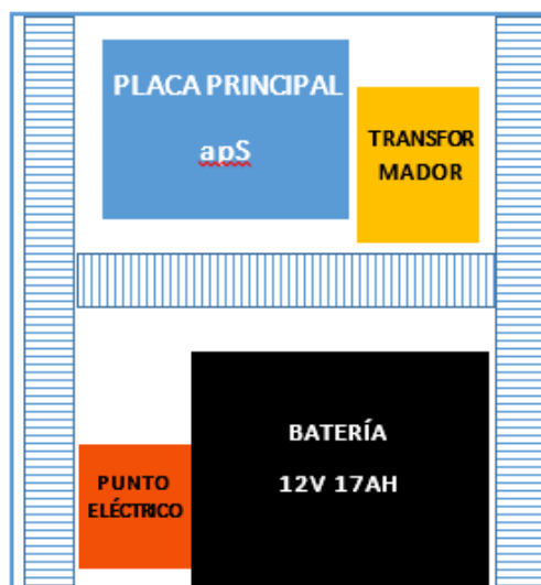
Gráfico 6. Distribución de elementos en el gabinete de la fuente para el sistema de facilidad de acceso
